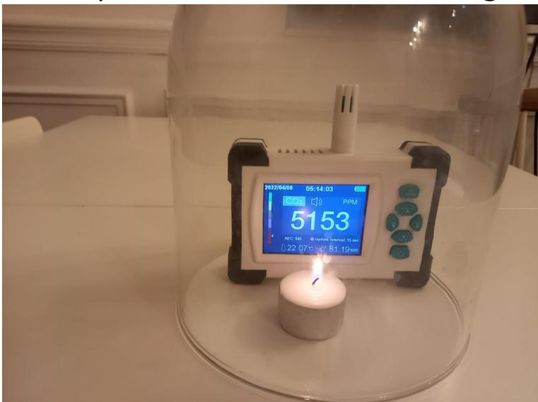
En relevant les valeurs toutes les 5 secondes, on peut tracer la courbe suivante. L'origine des temps correspond à la mise en place de la cloche.
