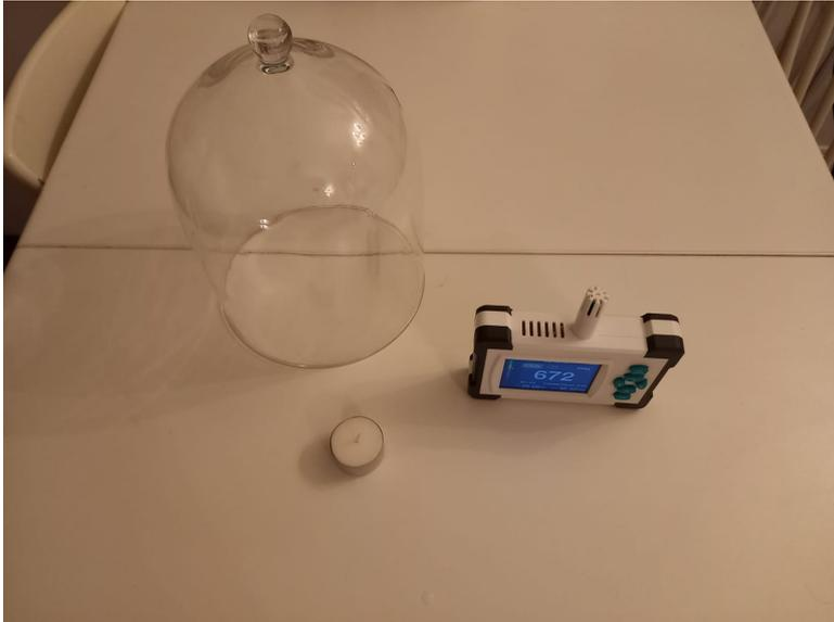
On allume la bougie, en la plaçant à une distance raisonnable du détecteur. On couvre le tout avec la cloche. On veille à ce que la chaleur de la flamme ne détériore pas le détecteur. Très rapidement le taux de CO2 augmente et on observe
